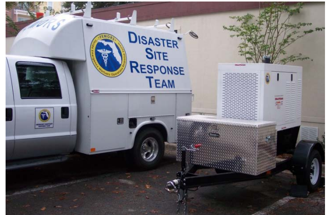
DPMU 16KW Generator
